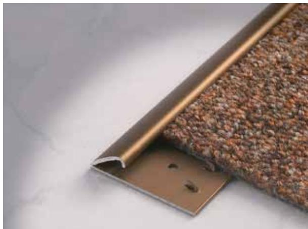
Terminali per pavimenti flessibili come moquettes e fibra di cocco. I profili, pressandoli, si chiudono imprigionando il rivestimento in modo duraturo coprendone i difetti di taglio e preservandone il bordo.
